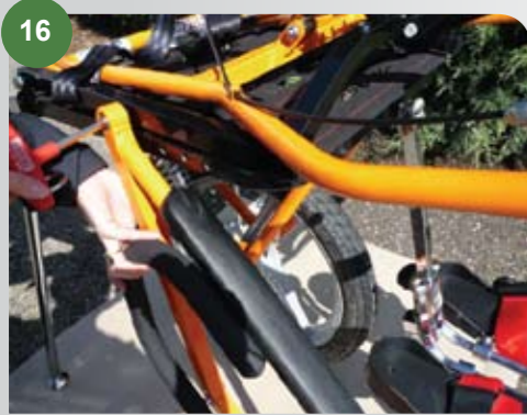
Attach the armrest with the bolt & key supplied / Engager le vis d'accouder sur le dossier avec la clé fournie
