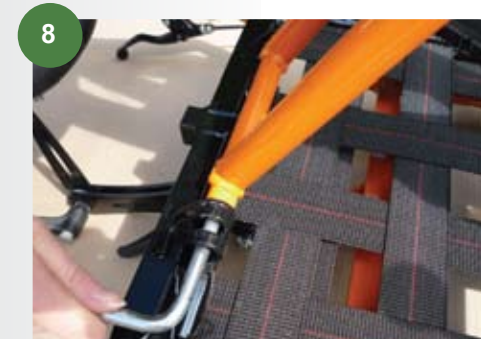
8 Put the axle in the position et block the wheel / Remettre l'axe dans son logement et bloquer la roue
