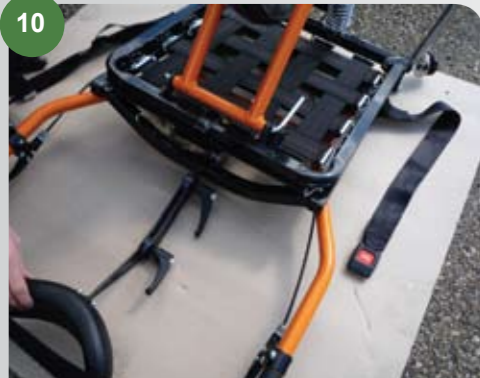
Extract the headrest / Dégager l'appui-tête
