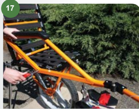
As for the seat, tighten the 2 bolts. Repeat the operation for the second shaft / De même pour l'assise et serrer les 2 vis. Répéter l'opération sur le second brancard
