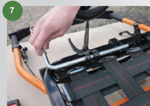
7 Pull the axle / Tirer l'axe de son logement
