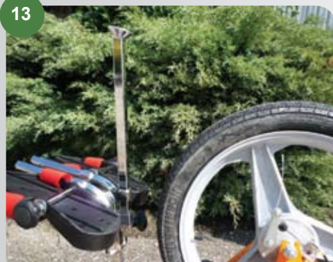
Unfold the front folding stand in the a vertical position / Déplier le pied rétractable à la verticale
