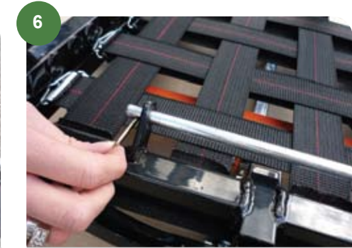
6 Remove the locking pins from the axle / Enlever la goupille de sécurité de l'axe
